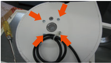
本体裏側のモーター & ファンを固定している ビス 4 本をはずします。
