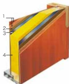
扉の単板とガルバリウム鋼板をサンドイッチすることにより、扉の反りを防ぎます。また、ドアに硬質ウレタンを充填することにより高い断熱性を保ちます。
