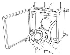
ファンモーターと本体内部を水拭きしてください。 取り付けは逆の手順で慎重に復帰させてください。
