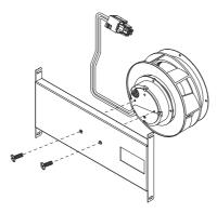
ファンモーター交換後、モーターホルダーを固定ビス2本で固定してください。 取り付けは逆の手順で慎重に復帰させてください。
