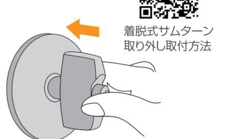
デッドボルトが収納された状態でタテ向きでボタンを押しながら取り付けて下さい。
